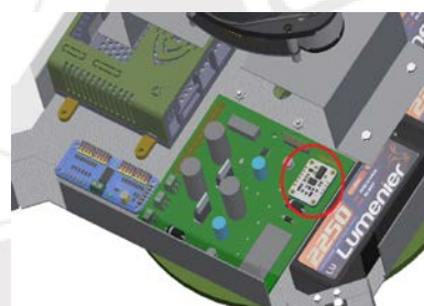
Figura 5.1.2: Módulo BNO055 en el robot (tapa superior transparente). Elaboración propia.
